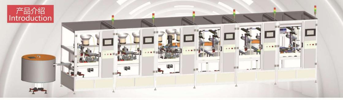
该设备包含零件装配、插拔力检测、介电强度测试等单元。是用来装配、测试墙壁插座的设备。插拔力检测可根据不同的要求进行设置。设备在0-50°C的环境下都能正常运行。整体机械结构设计合理,机械强度高,维护简单。
